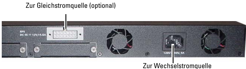
Abbildung 1-15. Wechselstrom- und Gleichstromversorgung zum Switch
